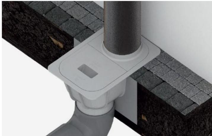
Wir installieren den Geiger im Boden und vergessen nicht, ihn an der endgültigen Geländeoberfläche auszurichten. Um den Boden der Baugrube für das Absetzbecken zu stabilisieren, füllen Sie ihn mit Beton auf und schließen Sie anschließend das Abwasserrohr an. Nachdem Sie das endgültige Bodenniveau ermittelt haben, decken Sie das Absetzbecken mit einer weiteren Betonschicht ab. Dann schließen wir das Fallrohr an.
