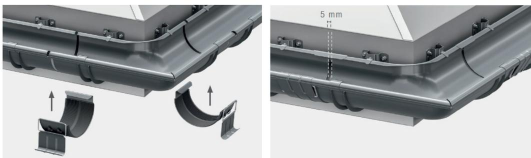
Die Eckstücke verbinden wir mittels Dachrinnenverbindern mit den Dachrinnen. Zur Stabilisierung des Systems müssen zusätzliche Haken verwendet werden. Für eine ordnungsgemäße Dilatation des Systems lassen wir am Übergang des Eckstücks zur Dachrinne 5 mm Platz. Zusätzliche Haken werden maximal 15 cm von der Mitte der Rinnenverbinder entfernt angebracht. Wir verbinden mittels verschiedener Arten von Verbindern.
