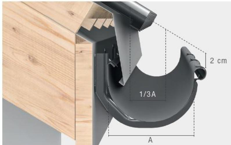
Durch eine ordnungsgemäße Installation soll die Dachrinne vor den Auswirkungen des vom Dach fallenden Schnees geschützt werden. Die Oberkante der Dachrinne sollte unter den Dachüberstand gesteckt werden.
