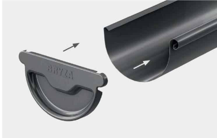
Die Endstücke sind so konzipiert, dass sie an beiden Enden der Dachrinne montiert werden können. Wir schieben das Endstück auf den Rand der Dachrinne.
