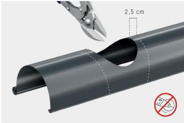
Reduzieren Sie den Durchmesser der Öffnung gegenüber dem zuvor markierten Stutzenrand um ca. 2,5 cm. Mit einer Blechschere schneiden wir die Öffnung für den Stutzen aus.
